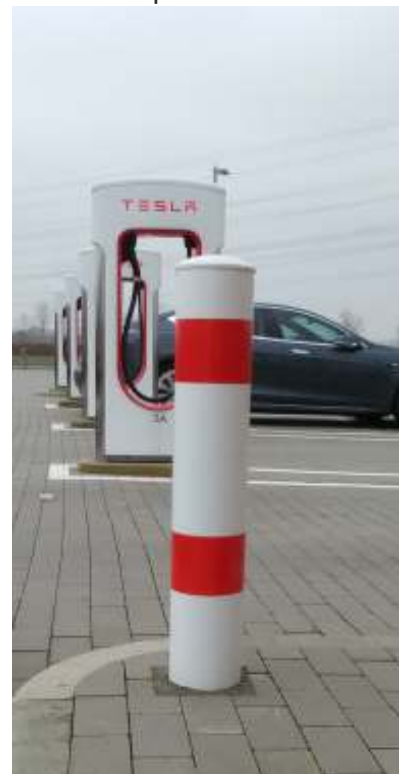
Beispiel Rammschutzpoller zum Aufdübeln
